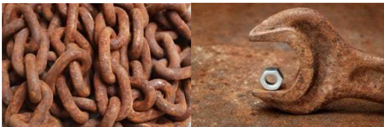
شکل ۲- ARABIC. Error! No sequence specified. ۱ خوردگیهای یکنواخت [۸].
