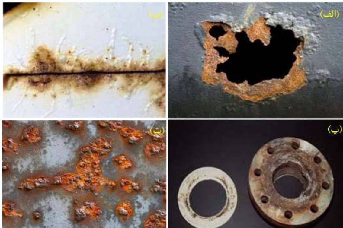
شکل ۲-۴- Error! No sequence specified. ARABIC (الف) خوردگی حفره دار شدن، (ب) خوردگی رشته‌ای، (پ) خوردگی شیار و (ت) خوردگی بین دانه‌ای [۹].
