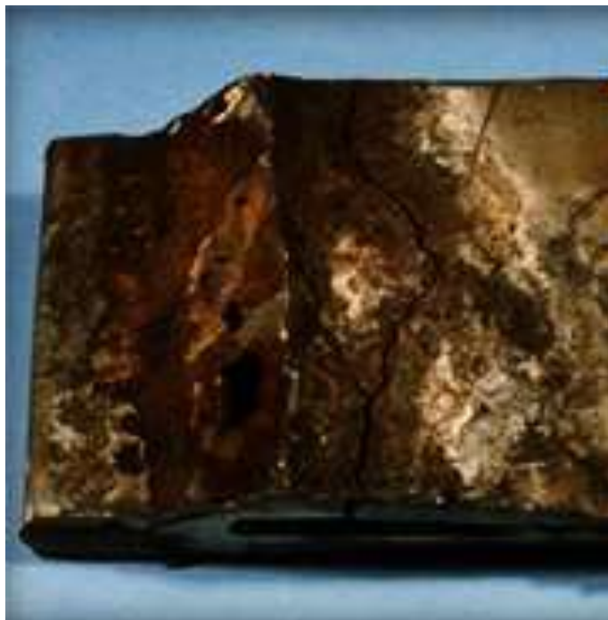
شکل ۲- ARABIC. Error! No sequence specified. ۶ خوردگی تنشی.
