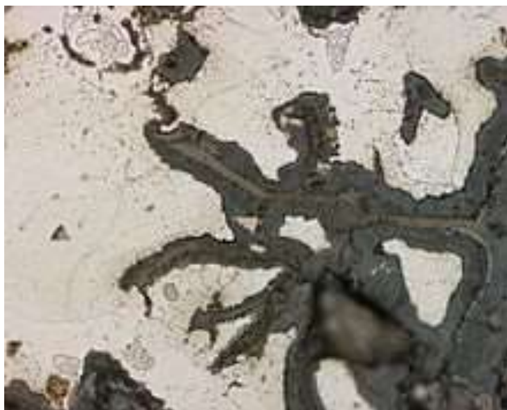
شکل ۲- ARABIC. Error! No sequence specified. خوردگی جدایش انتخابی [۹]
